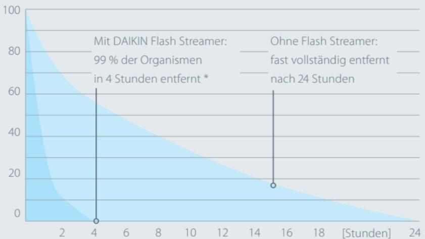
\* Das Testergebnis bezieht sich auf die vom photokatalytischen Titan-Apatit-Filter beseitigten Bakterien und Sporen. Dieser Filter ist Teil des DAIKIN Flash Streamers.
